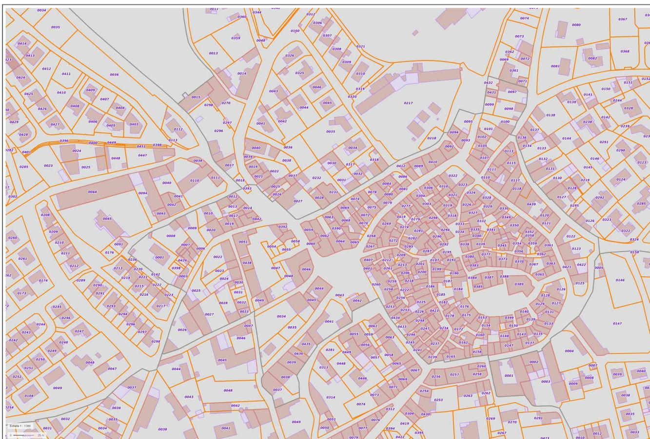
Cet extrait cadastral montre différents types de construction en proximité avec la place de la mairie au centre du plan, des constructions isolées sur une parcelle, des constructions doubles en mitoyenneté, des constructions en bande en double mitoyenneté, mais le plus caractéristique est la densité de (très) petites parcelles dans le centre historique, irrigué par des venelles étroites parfois en impasse.
